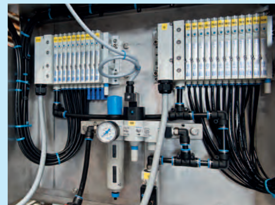
Door het MPA-L-ventieleiland van Festo behaalt de machine de gewenste snelheid en reproduceerbaarheid.
