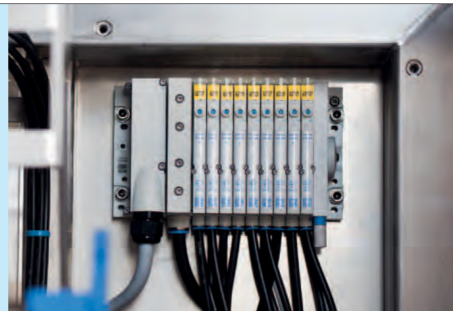
In de besturingskast van de machine zijn twee MPA-L-ventieleilanden opgenomen en tevens een luchtverzorgingsunit die de perslucht in de juiste kwaliteit aanbiedt.
